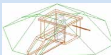
Das Innere des Baus wurde fledermausgerecht „möbliert“. Die Hohlblocksteine für Fledermauswinterquartiere zeichnen sich durch eine spezielle Lochgeometrie aus.
