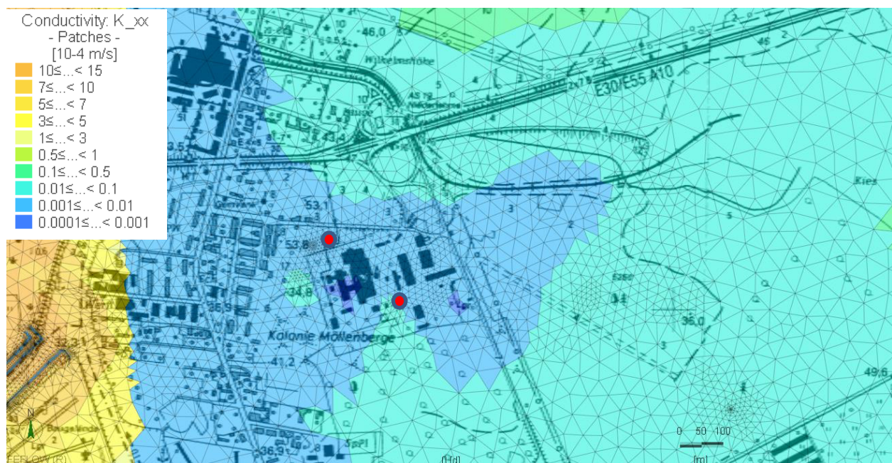
Abb. 8.7 Horizontale Modelldiskretisierung und k_f -Werte in der Einheit 10 -4 m/s im Grundwasserhemmer im Umfeld des Standorts MGS, rot: Brunnen der MGS
