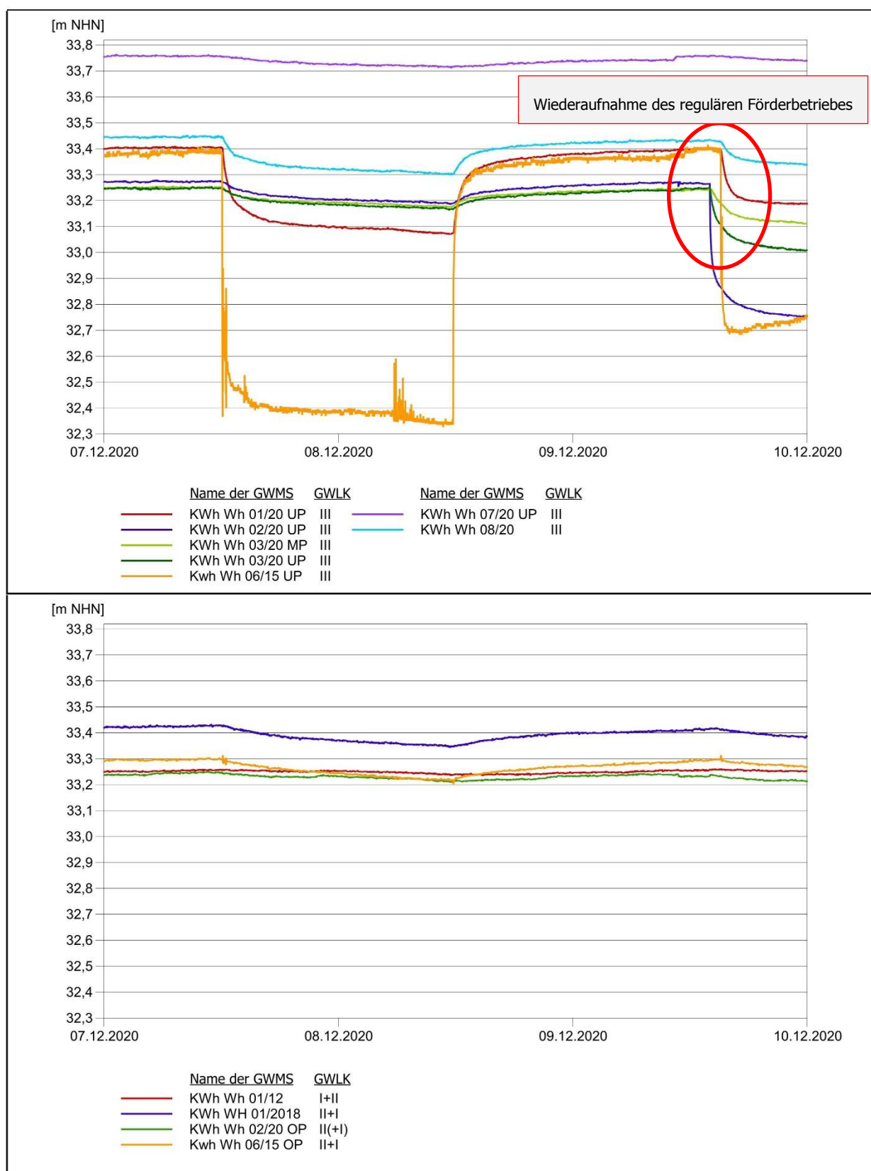
Abb. 5.4 Ganglinien des Grundwasserstandes während des Pumpversuches mit Br. 3/16 (Bezeichnung MGS: Brunnen 2)
