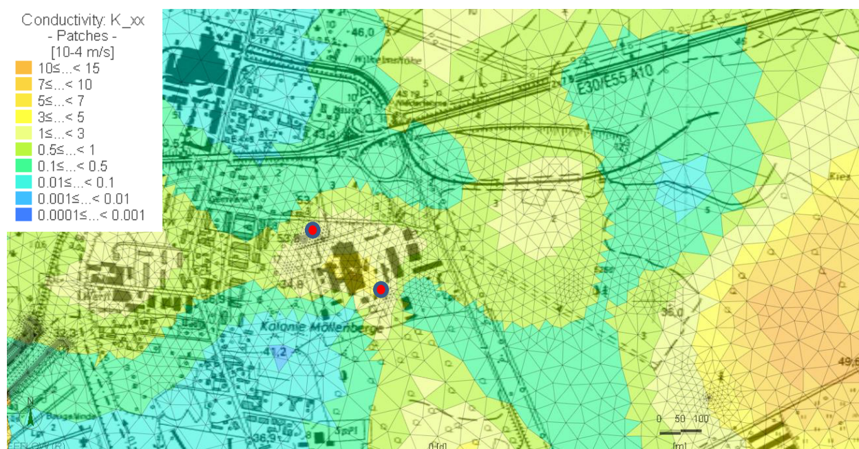
Abb. 8.8 Horizontale Modelldiskretisierung und k_f -Werte in der Einheit 10 -4 m/s im GWLK III im Umfeld des Standorts MGS, rot: Brunnen der MGS
