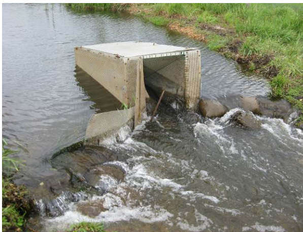
Erfolgskontrolle zum Fischaufstieg – Reuse an der stromobersten Schwelle
