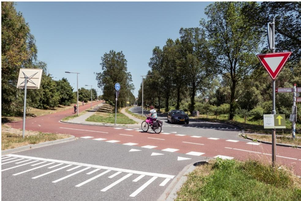
**Abbildung 9:** Bevorrechtigte Querung einer RSV (Bsp. Niederlande, eigenes Bild)
