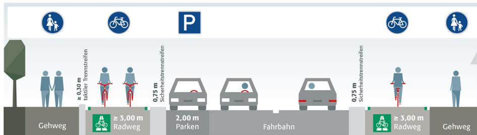
**Abbildung 3:** Musterquerschnitt RSV als Radweg im Einrichtungsverkehr
